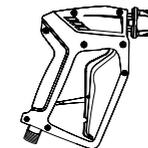
2. Sicherheits-Abschalt pistole mit Steckkupplung
