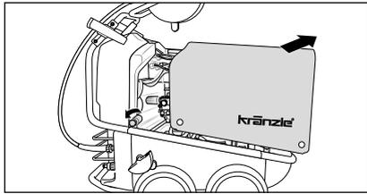
11. Um Zugriff zur Innenausstattung des Hochdruckreinigers zu bekommen, lösen Sie die Schrauben an der Abdeckung. Entnehmen Sie vorsichtig die Haube.
