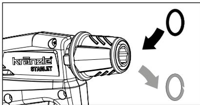
Schalten Sie den Hochdruckreiniger aus. Betätigen Sie zum Druckabbau kurz die Sicherheits-Abschaltpistole. Entfernen Sie Hochdruckschlauch, Sicherheits-Abschaltpistole sowie die Lanze und kontrollieren Sie die Dichtungsringe. Sind die Dichtungsringe defekt, sofort O-Ringe austauschen.
