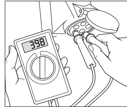
Sind in Ihrer Leitungsumgebung gleichzeitig zu viele Stromabnehmer am Netz, kann die zur Verfügung stehende Spannung sowie die Stromstärke deutlich sinken. In der Folge läuft der Motor des Hochdruckreinigers nicht an oder brennt durch. Die Stromversorgung kann auch mangelhaft sein, wenn das Netzanschlusskabel zu lang oder zu dünn ist. Zu lange Verlängerungskabel verursachen einen Spannungsabfall und dadurch Betriebsstörungen und Anlaufschwierigkeiten.
