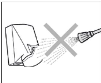
Den Hochdruckstrahl nicht auf Steckdosen oder andere elektrische Einrichtungen richten!
