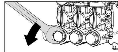
Entnehmen Sie die Schraube mit Ventilkörper samt O-Ring. Kontrollieren Sie den Dichtungsring auf Beschädigung. Bei Beschädigung muss der O-Ring ausgetauscht werden.
