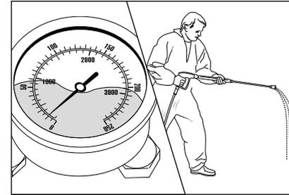
Das Edelstahlmanometer zeigt trotz aufgedrehter Druckregulierung nur wenig Druck.
