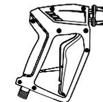
2. Sicherheits-Abschalt pistole mit Steckkupplung
