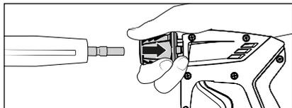
8. Nach Einstecken der Lanze die Sicherungshülse loslassen und auf einen sicheren Sitz der Lanze achten. **Stecknippel regelmäßig mit säurefreiem Fett einschmieren.**
