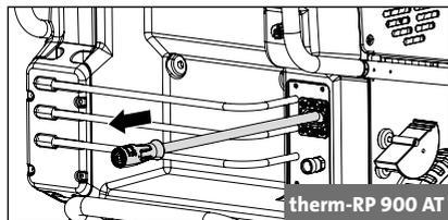
6. Hochdruckschlauch (drehbare Verschraubung - grau) an die Sicherheits-Abschalt-pistole aufstecken, fest und druckdicht verschrauben.
