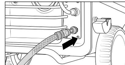
10. Wasserschlauch am Wassereingang anschließen (Mindestanforderungen: 5 m Schlauchlänge, Querschnitt 3/4", 10 bar). Der Hochdruckreiniger kann wahlweise an eine Druckwasserleitung (1 - 10 bar Vordruck) mit kaltem oder bis zu 60 °C warmem Wasser angeschlossen werden.
