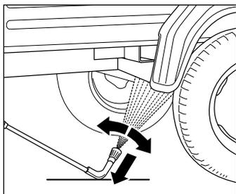
Bei Verwendung der Unterbodenlanze muss diese unbedingt aufgelegt werden!
