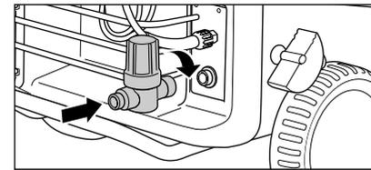
1. Montieren Sie den Wassereingangsfilter am Wassereingang.
