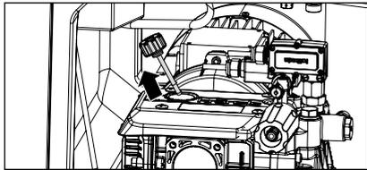
12. **Vor jeder Inbetriebnahme Ölstand am Ölmesstab überprüfen.** Ölstand muss zwischen der ersten und der zweiten Markierung ablesbar sein. Siehe Kapitel „Pflege und Wartung“ in dieser Betriebsanleitung.
