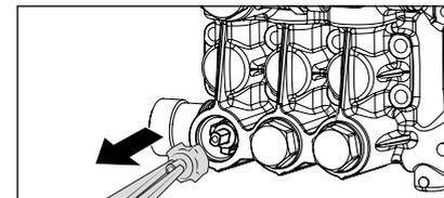
Säubern Sie die Ventile mit einem Draht (Büroklammer) und möglichst unter fließendem Wasser.
