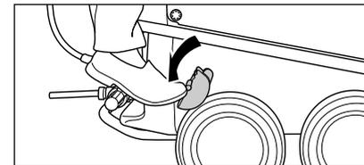
3. Um den Hochdruckreiniger zum Einsatzort bewegen zu können, lösen Sie die Feststellbremse. **Der Hochdruckreiniger darf nicht mit angeschlossenem Wasserzuleitungsschlauch gezogen werden!**
