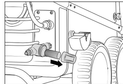
9. **Vor jeder Inbetriebnahme Wassereingangssieb auf Sauberkeit überprüfen.** Filterbecher per Hand abschrauben, das Wassereingangssieb herausnehmen und mit den restlichen Teilen unter klarem Wasser gründlich ausspülen und reinigen. Ist das Sieb verschmutzt kann kein Wasser durchlaufen und sich dadurch kein Druck aufbauen.
