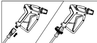
7. Die Sicherungshülse der Sicherheits-Abschalt-pistole erst zurückziehen, dann die Lanze in die Steckkupplung der Sicherheits-Abschalt-pistole stecken.
