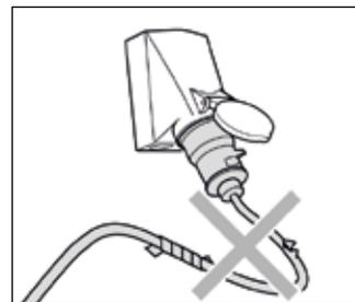
Netzanschlusskabel nur in einwandfreiem Zustand verwenden! Netzanschlusskabel nicht beschädigen (zerren, quetschen, überfahren, ...) oder unsachgemäß reparieren!
