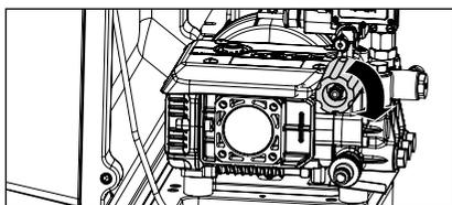
15. Arbeitsdruck stufenlos mit dem Drehgriff regeln. Der maximal verfügbare Arbeitsdruck ist werkseitig fest eingestellt.
