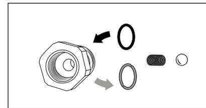
Sind die Dichtungsringe defekt, sofort O-Ringe austauschen.
