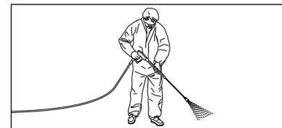
3. Bei Beginn des Waschvorgangs den Hochdruckstrahl mindestens 30 Sekunden lang **nicht** auf das Reinigungsobjekt halten. Es ist möglich, dass sich der Wasserinhalt der Brennkammer durch die Ruhezeit verfärbt hat.
