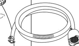
**Saugschlauch mit Ansaugfilter**
