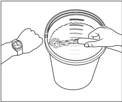
Wassermangel kommt häufiger vor als man denkt. Je leistungsstärker ein Hochdruckreiniger ist, umso größer ist die Gefahr, dass zu wenig Wasser zur Verfügung steht. Bei Wassermangel entsteht in der Hochdruckpumpe Kavitation (Wasser-Gas-Gemisch), was in der Regel nicht oder zu spät bemerkt wird.
