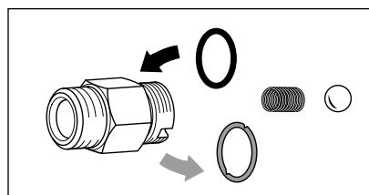
V případě poškození vyměňte těsnící O-kroužky.
