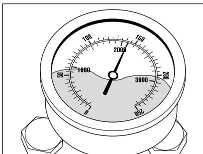
Po zavření bezpečnostní vypínačí pistole musí být přepnut pojistný ventil pro regulaci tlaku. Manometr z nerezové oceli musí nyní ukazovat hodnotu „0“ barů. Pokud nedojde k přepnutí a na manometru z nerezové oceli je i nadále zobrazen maximální tlak, může být příčinou tohoto jevu netěsnost vysokotlakého čerpadla, tlakového spínače, vysokotlaké hadice nebo bezpečnostní vypínačí pistole.
