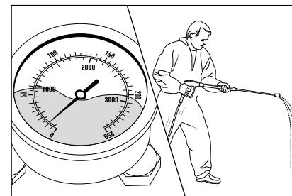
I přes otevřenou regulaci tlaku ukazuje manometr z nerezové oceli málo tlaku. Z trubice vychází nepravidelný vodní paprsek. Vysokotlaká hadice vibruje.
