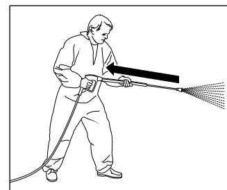
Pamatujte, že při čištění vodou pod vysokým tlakem dochází na trubici ke vzniku citelného zpětného rázu. Proto nezapomeňte na stabilní postoj (viz technické údaje).
