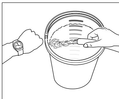
Nedostatek vody se vyskytuje častěji, než si myslíte. Čím výkonnější je vysokotlaký čisticí přístroj, tím větší hrozí nebezpečí, že bude k dispozici málo vody. V případě nedostatku vody dochází v čerpadlu ke kavitaci (směs vody a plynu), čehož si zpravidla nevšimneme, nebo si toho všimneme příliš pozdě. **Dojde ke zničení vysokotlakého čerpadla.** Množství vody, které je k dispozici, zkонтrolujte jednoduše tím, že budete plnit po jednu minutu kbelík s litrovou stupnicí.
