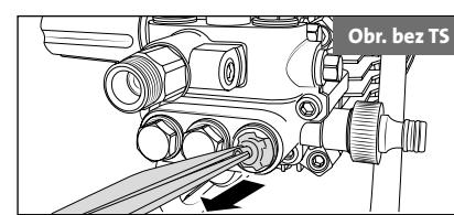
Odeberte šroub s tělesem ventilu včetně O kroužku. Zkontrolujte těsnící kroužek, zda není poškozen. V případě poškození je třeba O kroužek vyměnit.
