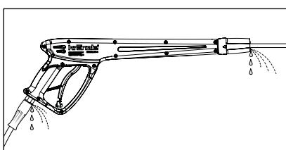
Vysokotlaký čistící přístroj vypněte. K uvolnění tlaku krátce aktivujte bezpečnostní vypínačí pistoli. Vyjměte vysokotlakou hadici, bezpečnostní vypínačí pistoli a trubici a zkontrolujte těsnící kroužky. V případě poškození vyměňte těsnicí O-kroužky.
