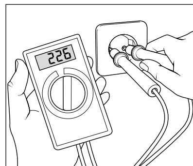
Je-li v okolí vedení na síť připojeno zároveň příliš mnoho odběratelů elektrické energie, může napětí i intenzita proudu, jež je k dispozici, citelně poklesnout. Následkem toho motor vysokotlakého čističe nenaběhne, nebo zcela shoří. Napájení elektrickým proudem může být také chybné, je-li kabel elektrického proudu příliš dlouhý nebo tenký. Příliš dlouhé prodlužovací kably způsobují pokles napětí a tím provozní poruchy a problémy se spouštěním a rozebíháním zařízení.
