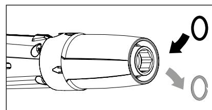
Vysokotlaký čisticí přístroj vypněte. K uvolnění tlaku krátce aktivujte bezpečnostní vypínači pistoli. Vyjměte vysokotlakou hadici, bezpečnostní vypínači pistoli a trubici a zkontrolujte těsnící kroužky. V případě poškození vyměňte těsnící O-kroužky.
