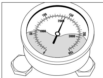
Po uzavření bezpečnostní vypínači pistole se vysokotlaký čisticí přístroj musí vypnout. Manometr z nerezové oceli musí nyní ukazovat hodnotu „0“ barů. „Pokud nedojde k vypnutí a na manometru z nerezové oceli je i nadále maximální tlak, může být příčinou tohoto jevu netěsnost, vysokotlakého čerpadla, tlakového spínače, vysokotlaké hadice nebo bezpečnostní vypínači pistole.“
