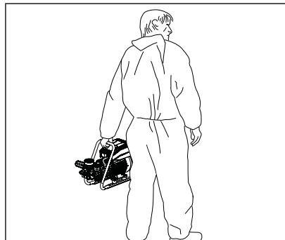
1. HD 9/80, HD 9/80 TS, HD 12/130 nebo HD 12/130 TS přineste na místo použití. Při umisťování vysokotlakého čisticího přístroje dbejte, aby byl stabilně postaven.
