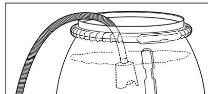
2. Заполненный водой всасывающий шланг ввести в емкость и начать процесс чистки.
