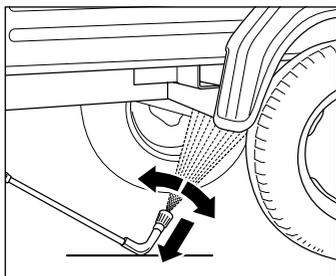
При использовании копы для чистки днища снизу копы обязательно следует опустить на землю! Следует учесть, что на изогнутых и угловых распылительных копиях возникает значительный крутящий момент вследствие реактивного эффекта! (Копье для чистки днища является принадлежностью и может быть заказано в качестве опциона.)
