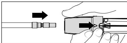
5. Предохранительную гильзу безопасного отключаемого пистолета сначала оттянуть назад, а затем установить копьё в соединительную муфту безопасного отключаемого пистолета.
