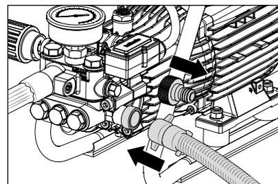
1. Установить всасывающий шланг с всасывающим фильтром (арт. № 150383).
