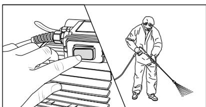
11. Включить очиститель высокого давления при открытом безопасном отключаемом пистолете. Удалить воздух из очистителя высокого давления: несколько раз открыть и закрыть безопасный отключаемый пистолет. Начать процесс чистки.
