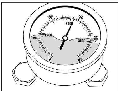
После закрытия безопасного отключаемого пистолета очиститель высокого давления должен отключиться. Манометр, изготовленный из нержавеющей стали, должен теперь показывать «0» бар. Если отключение не произойдет, а манометр будет дальше показывать полное давление, то причиной могут быть утечки у насоса высокого давления, реле давления, шланга высокого давления или безопасного отключаемого пистолета.
