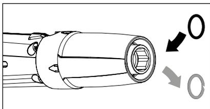
Выключите очиститель высокого давления. Кратковременно включите безопасный отключаемый пистолет для снятия давления. Снимите шланг высокого давления, безопасный отключаемый пистолет, а также копы и проверьте уплотнительные кольца. Если уплотнительные кольца неисправные, то кольца круглого сечения сразу же заменить.
