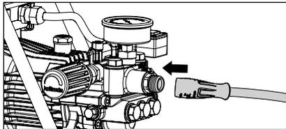
3. Крепко и герметично прикрутить к выходу насоса входящий в объем поставки шланг высокого давления.
