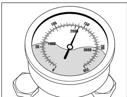
После закрытия безопасного отключаемого пистолета необходимо переключить предохранительный клапан регулирования давления. Манометр, изготовленный из нержавеющей стали, должен теперь показывать «0» бар. Если отключение не произойдет, а манометр будет дальше показывать полное давление, то причиной могут быть утечки у насоса высокого давления, реле давления, шланга отключаемого пистолета.
