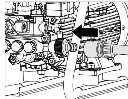
8. Присоединить водяной шланг к входу воды (минимальные требования: длина шланга 5 м, поперечное сечения 3/4", 10 бар). Очиститель высокого давления можно выборочно подключать к напорной линии (давление на входе 1–10 бар) с холодной водой или с горячей водой, имеющей температуру до 60 °C. У HD 9/80, HD 9/80 TS, HD 12/130 и HD 12/130 TS имеется возможность засасывания воды из одного бака (см. прямое всасывание).
