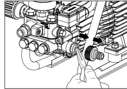
7. **Перед каждым пуском в работу проверять чистоту сетки на входе воды.** Вручную открутить соединительную муфту. Острыми щипцами вынуть сито, установленное на входе воды, и тщательно промыть чистой водой и прочистить вместе с остальными деталями. Если сито загрязнено, вода не сможет протекать, а в результате этого не сможет создаться давление.
