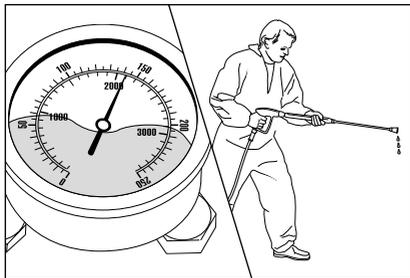
Манометр, изготовленный из нержавеющей стали, показывает полное давление. Из сопла не течет или течет слишком мало воды.
