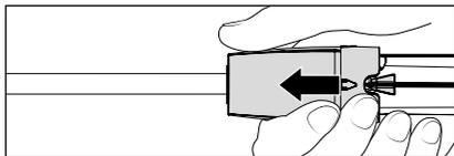
6. После установки копыя отпустить предохранительную гильзу и обеспечить надежную посадку копыя. **Соединительный ниппель регулярно смазывать смазкой, не содержащей кислотных веществ.**
