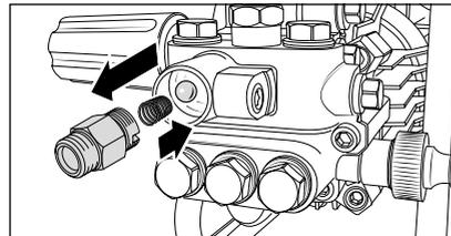
Шарик отдачи вынуть, а кольцо круглого сечения проверить на наличие загрязнения или повреждения. Проверить также плотность посадки в корпусе насоса на наличие загрязнения или повреждения.
