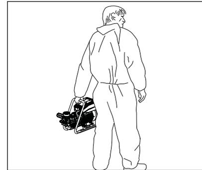
1. HD 9/80, HD 9/80 TS, HD 12/130 или HD 12/130 TS принести на место эксплуатации. При установке очистителя высокого давления на пол обеспечить его устойчивость.
