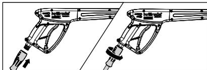
4. Наденьте серый вращающийся резьбовой соединитель шланга высокого давления на безопасный отключаемый пистолет. Прикрутите их затем крепко и герметично друг ко другу.
