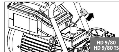
9. **HD 9/80, HD 9/80 TS: Перед каждым пуском в работу проверять уровень масла по щупу определения уровня масла.** Уровень масла должен достигать верхней кромки маркировки "OK".
