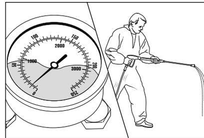
Изготовленный из нержавеющей стали манометр, несмотря на установку максимального давления, показывает низкое давление. Из сопла выходит непостоянная струя. Вибрация шланга высокого давления. (В манометре, изготовленном из нержавеющей стали, нет воды, речь идет о глицерине для демпфирования вибрации стрелки.)
