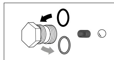
V případě poškození vyměňte těsnicí O-kroužky.
