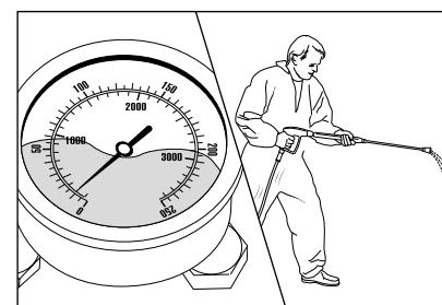
I přes otevřenou regulaci tlaku ukazuje manometr z nerezové oceli málo tlaku. Z trubice vychází nepravidelný vodní paprsek. Vysokotlaká hadice vibruje.
