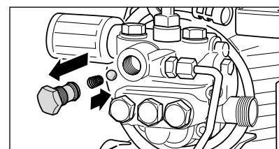
Vyjměte zpětné těleso a zkontrolujte, zda není O kroužek znečištěný nebo poškozený. Zkontrolujte také těsnicí sedlo v tělesu čerpadla, zda není znečištěné nebo poškozené.
