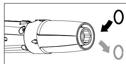
Vysokotlaký čisticí přístroj vypněte. K uvolnění tlaku krátce aktivujte bezpečnostní vypínači pistoli. Vyjměte vysokotlakou hadici, bezpečnostní vypínači pistoli a trubici a zkontrolujte těsnící kroužky. V případě poškození vyměňte těsnicí O-kroužky.
