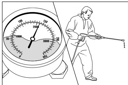
Манометр, изготовленный из нержавеющей стали, показывает полное давление. Из копья не течет или течет слишком мало воды.
