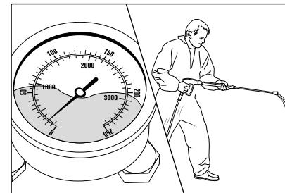
Изготовленный из нержавеющей стали манометр, несмотря на установку максимального давления, показывает низкое давление. Из копья выходит непостоянная струя. Вибрация шланга высокого давления. (В манометре, изготовленном из нержавеющей стали, нет воды, речь идет о глицерине для демпфирования вибрации стрелки.)
