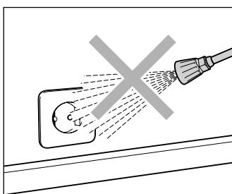
Водяную струю не направлять на розетки или другие электрические устройства! Все токоведущие части, расположенные в рабочей зоне, должны быть брызгозащищенными.
