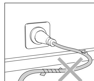
Кабель для подключения к сети использовать только в исправном состоянии! Не повреждать кабель для подключения к сети (не тянуть, не защемлять, не переезжать через него и т.д.), его неквалифицированный ремонт запрещается!
