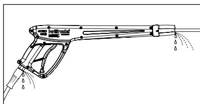
Выключите очиститель высокого давления. Кратковременно включите безопасный отключаемый пистолет для создания давления. Снимите шланг высокого давления, пистолет и копье проверьте уплотнительные кольца. Если уплотнительные кольца неисправные, то кольца круглого сечения сразу же заменить.
