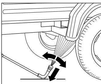
При использовании копья для чистки днища снизу копье обязательно следует опустить на землю! Следует учесть, что на изогнутых и угловых распылительных копьях возникает значительный крутящий момент вследствие реактивного эффекта! (Копье для чистки днища является принадлежностью и может быть заказано в качестве опциона.)
