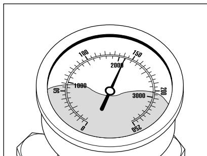
После закрытия безопасного отключаемого пистолета очиститель высокого давления должен отключиться. Манометр, изготовленный из нержавеющей стали, должен теперь показывать «0» бар. Если отключение не произойдёт, а манометр будет дальше показывать полное давление, то причиной могут быть утечки у насоса высокого давления, реле давления, шланга высокого давления или безопасного отключаемого пистолета.
