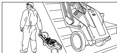
1. V případě vysokotlakých čisticích přístrojů musíte před prvním použitím instalovat ruční kliku. Postavte vysokotlaký čisticí přístroj na místo. Nasadte kliku na šestihran a upevněte ji šroubem a podložkou.
