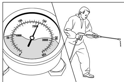
Manometr z nerezové oceli ukazuje maximální tlak. Z trubice nevytéká žádná nebo jen velmi málo vody.
