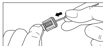
Odeberte šroub s tělesem ventilu včetně O kroužku. Zkontrolujte těsnící kroužek, zda není poškozen. V případě poškození je třeba O kroužek vyměnit.
