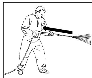
Pamatujte, že při čištění vodou pod vysokým tlakem dochází na trubici ke vzniku citelného zpětného rázu. Proto nezapomeňte na stabilní postoj (viz technické údaje).
