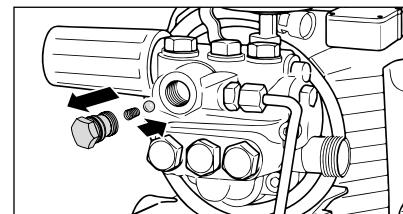
Vyjměte zpětné těleso a zkontrolujte, zda není O kroužek znečištěný nebo poškozený. Zkontrolujte také těsnicí sedlo v tělese čerpadla, zda není znečištěné nebo poškozené.
