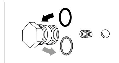
V případě poškození vyměňte těsnicí O-kroužky.
