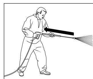
Учтите, что при чистке водой под высоким давлением на копье возникает ощущимая отдача. Поэтому обеспечьте устойчивость его положения (см. технические данные).
