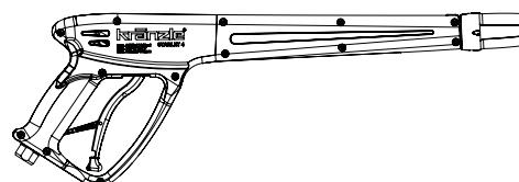
2. Безопасный отключаемый пистолет с соединительной муфтой
