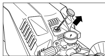
7. **Перед каждым пуском в работу проверять чистоту сетки на входе воды.** Вручную открутить соединительную муфту. Острыми щипцами вынуть сите, установленное на входе воды, и тщательно промыть чистой водой и прочистить вместе с остальными деталями. Если сите загрязнено, вода не сможет протекать, а в результате этого не сможет создаться давление.
