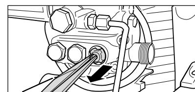
Снимите винт с корпусом клапана и кольцом круглого сечения. Проверьте уплотнительное кольцо на наличие повреждений. В случае повреждения кольцо круглого сечения следует заменить.
