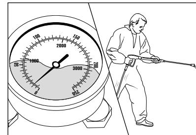
Изготовленный из нержавеющей стали манометр, несмотря на установку максимального давления, показывает низкое давление. Из копья выходит непостоянная струя. Вибрация шланга высокого давления.
