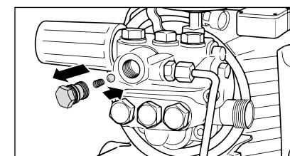
Шарик отдачи вынуть, а кольцо круглого сечения проверить на наличие загрязнения или повреждения. Проверить также плотность посадки в корпусе насоса на наличие загрязнения или повреждения.
