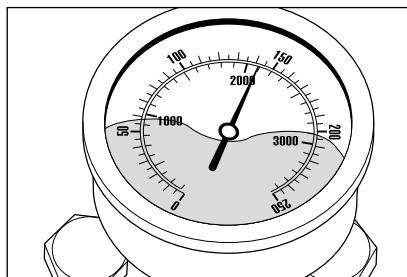
После закрытия безопасного отключаемого пистолета очиститель высокого давления должен отключиться. Манометр, изготовленный из нержавеющей стали, должен теперь показывать «0» бар. Если отключение не произойдёт, а манометр будет дальше показывать полное давление, то причиной могут быть утечки у насоса высокого давления, реле давления, шланга высокого давления или безопасного отключаемого пистолета.
