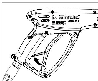
Предохранительный затвор на безопасном отключаемом пистолете перекидывать после каждого пользования, чтобы предотвратить непроизвольное распыление.
