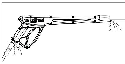
Выключите очиститель высокого давления. Кратковременно включите безопасный отключаемый пистолет для снятия давления. Снимите шланг высокого давления, безопасный отключаемый пистолет, а также копье и проверьте уплотнительные кольца. Если уплотнительные кольца неисправны, то кольца круглого сечения сразу же заменить.
