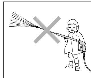
Vodite računa o tome da prilikom čišćenja vodom pod visokim tlakom nastaje osjetno jaka povratna udarna sila na mlaznici za prskanje. Zbog toga je važno zauzeti čvrst položaj (vidi tehničke podatke).
