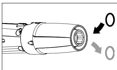
Isključite visokotlačni uređaj za čišćenje. Kratko pritisnite pištolj sa sigurnosnim isključivanjem kako bi se smanjio tlak. Odvrnute visokotlačno crijevo, pištolj sa sigurnosnim isključivanjem i koplje za prskanje te provjerite prstenove za brtvljenje. Ukoliko su prstenovi za brtvljenje oštećeni, odmah zamijenite O-prstenove.
