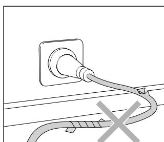
Upotrebljavati strujni priključni kabel samo u ispravnom stanju! Nemojte oštetiti kabel (potezati, pritiskati, gaziti itd.) ili ga nestručno popravljati!
