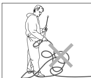
Nemojte savijati visokotlačno crijevo ili ga povlačiti ako se zapetljalo! Visokotlačno crijevo ne smije se povlačiti preko oštih rubova!
