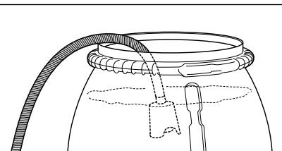
**Prije prvog postupka usisavanja, visokotlačna pumpa i usisno crijevo moraju biti napunjeni vodom.**
