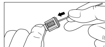
Šiljastim kliještima izvadite tijelo ventila i O-prsten. Provjerite postoje li oštećenja na prstenu za brtvljenje. Ako postoje oštećenja O-prsten se mora zamijeniti novim.
