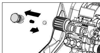
Izvaditi tijelo ventila i provjeriti postoje li oštećenja ili zaprljanja na O-prstenu. Provjerite također zabrtvljenošć u kućištu pumpe te postoje li oštećenja ili zaprljanja.
