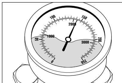
Nakon zatvaranja pištolja sa sigurnosnim isključivanjem, uređaj se mora ugasiti. Manometar mora pokazati „0“ bara. Ukoliko se uređaj ne ugasni, a manometar i dalje pokazuje maksimalni tlak, uzrok može biti curenje na visokotlačnoj pumpi, tlačnoj sklopici, visokotlačnom crijevu ili na pištolju sa sigurnosnim isključivanjem.
