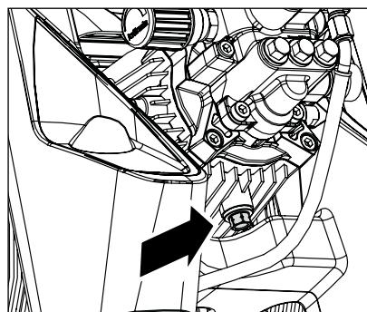
Prva zamjena ulja mora se izvršiti nakon **50 sati rada uređaja**. Svaku sljedeću zamjenu ulja bitno je izvršiti jednom godišnje ili nakon 250 sati rada uređaja. Ukoliko ulje poprimi sivu ili bijelu boju, obvezno ga treba zamijeniti novim uljem. Ukoliko je potrebno zamijeniti ulje, otvorite ispusni poklopac za ulje iznad prihvratne posude i ispraznite ulje iz uređaja. Ulje se mora ispustiti u posudu te se mora ukloniti u skladu s važećim propisima.
