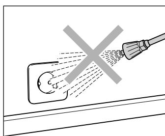
Ne usmjeravati mlaz vode prema utičnicama ili drugim električnim instalacijama!
