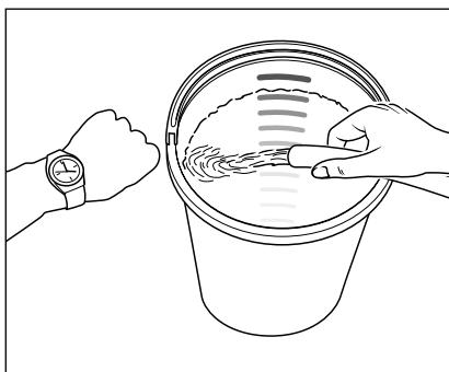
Problem nedostatka vode pojavljuje se češće nego što se misli. Što je snažniji visokotlačni uređaj za čišćenje, tim je veća opasnost od manjka vode na raspolaganju. U slučaju manjka vode nastaje kavitacija u pumpi (mješavina vode i plina), što se po pravilu kasno ili uopće ne primijeti. **Pumpa će biti uništena!** Jednostavno provjerite količinu vode koja je na raspolaganju tako što ćete 1-litarsku posudu puniti 1 minutu.
