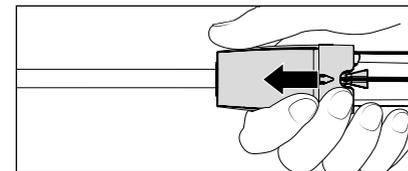
6. После установки копьё отпустить предохранительную гильзу и обеспечить надежную посадку копьё. **Соединительный ниппель регулярно смазывать смазкой, не содержащей кислотных веществ.**
