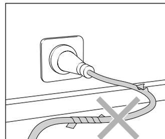
Кабель для подключения к сети использовать только в исправном состоянии! Не повреждать кабель для подключения к сети (не тянуть, не защемлять, не переезжать через него и т.д.), его неквалифицированный ремонт запрещается!
