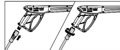
4. Насадить шланг высокого давления на безопасный отключаемый пистолет, крепко и герметично закрутить.
