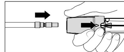
5. Предохранительную гильзу безопасного отключаемого пистолета сначала оттянуть назад, а затем установить копьё в соединительную муфту безопасного отключаемого пистолета.
