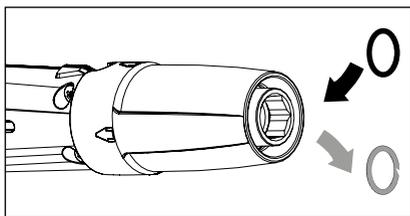
Выключите очиститель высокого давления. Кратковременно включите безопасный отключаемый пистолет для создания давления. Снимите шланг высокого давления, пистолет и копы и проверьте уплотнительные кольца. Если уплотнительные кольца неисправные, то кольца круглого сечения сразу же заменить.
