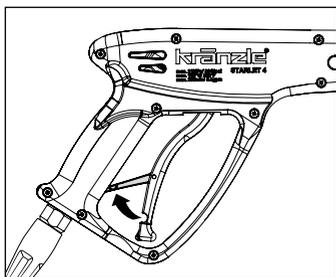
Предохранительный затвор на безопасном отключаемом пистолете перекидывать после каждого пользования, чтобы предотвратить произвольное распыление.
