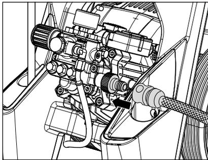
Подсоединить шланг к входу воды (минимальные требования: длина шланга 5 м, поперечное сечения  $\frac{3}{4}$ ", 10 бар). Очиститель высокого давления можно выборочно подключать к напорной линии (давление на входе 1–10 бар) с холодной водой или с горячей водой, имеющей температуру до 60 °С. У X 8/150 TST имеется возможность засасывания воды из одного бака (см. прямое всасывание).
