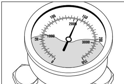
После закрытия безопасного отключаемого пистолета очиститель высокого давления должен отключиться. Манометр, изготовленный из нержавеющей стали, должен теперь показывать «0» бар. Если отключение не произойдет, а манометр будет дальше показывать полное давление, то причиной могут быть утечки у насоса высокого давления, реле давления, шланга высокого давления или безопасного отключаемого пистолета.
